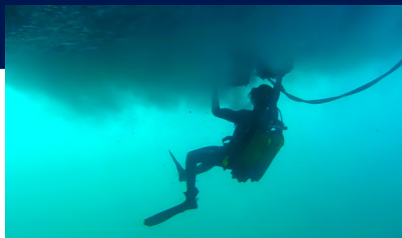
Limpeza de casco com escovas hidráulicas
