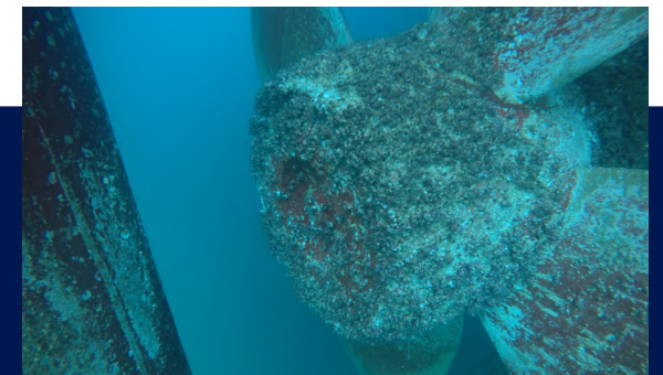
Imagem capturada por ROV, para análise da condição da hélice
