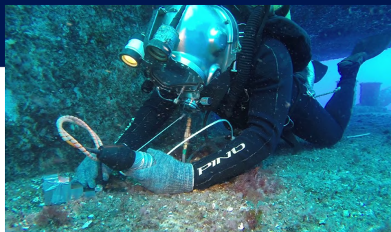
Medição de Espessura por Ultrassom
