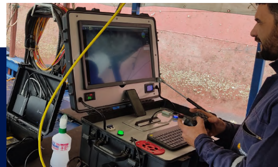
Sistema remoto do operador de ROV para inspeção visual subaquática
