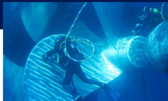
Polimento de hélice subaquático
